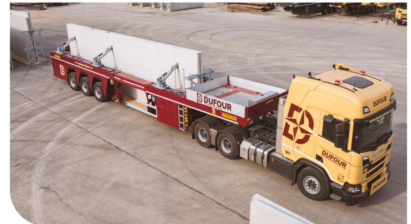
La semi-remorque « tiroir » PrefaMAX est la solution éprouvée la plus avancée pour le transport des éléments préfabriqués et autres charges spéciales. Le chargement et le déchargement sont effectués rapidement et en toute sécurité. Ils peuvent être réalisés indépendamment d'un camion élévateur ou d'un chariot élévateur à fourche, car le PrefaMAX peut récupérer une palette de chargement à l'aide d'un levage hydraulique ou pneumatique.
